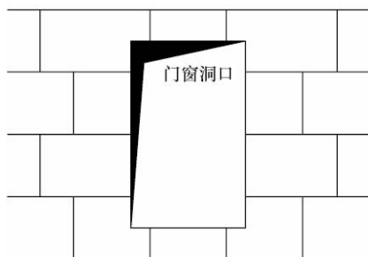
图 5.4.1-2 门窗洞口岩棉排布示意
